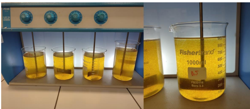
Obrázok 1 Pohľad na proces koagulácie počas pomalého miešania s otáčkami 15 RPM.
