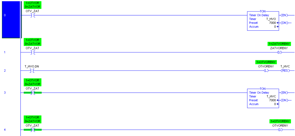
Obr.14: Algoritmus simulácie ventilov
