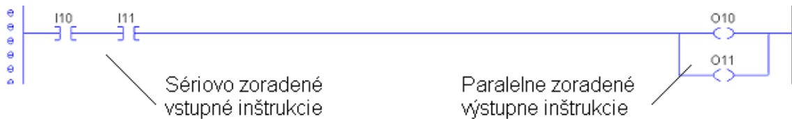
Obr.7: Sériové a paralelné zapojenie inštrukcií
