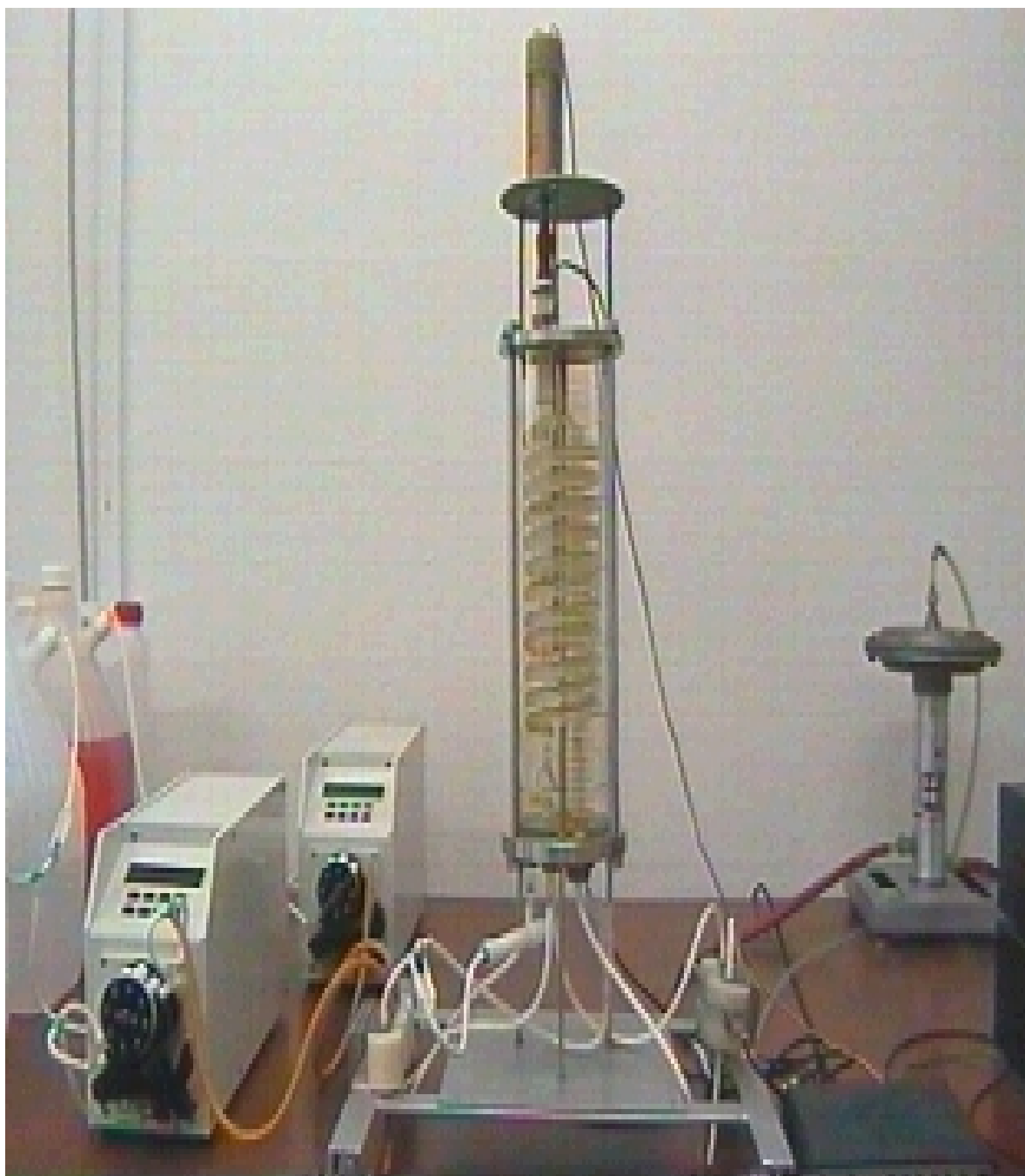
Laboratórny chemický prietokový reaktor s miešaním
